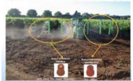
Comparaison de différentes buses sur un pulvérisateur agricole à jet porté
